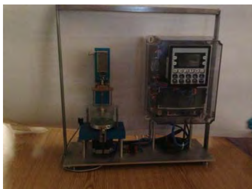
Fig 4. Platforma automata pentru senzorii de pesticide (stanga); senzorul de pesticide de unica folosinta (centru); incubarea enzimei imobilizata pe senzor in Chlorpyrifos (dreapta)
