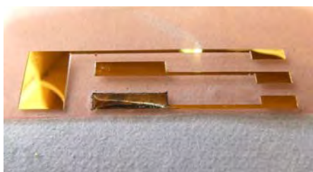
Fig. 1. Senzor realizat cu Ink Jet Printer
