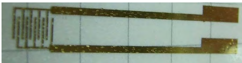
Fig 6. Senzorul impedimetric de Au pe PET obtinut prin tehnologia InkJet
