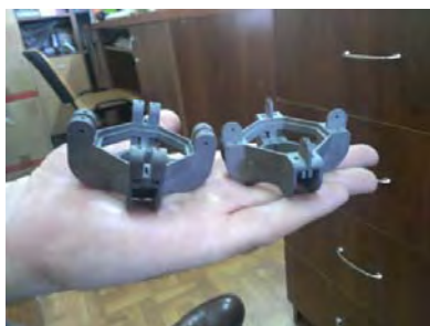
a.) Fotografie care arată dimensiunea reală a părților metalice ale senzorului de torsiune.
