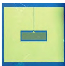
Antena pe grafena la frecvența de 10 GHz
