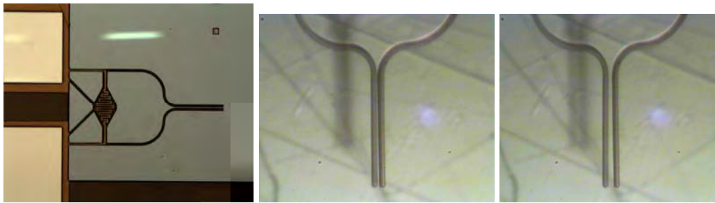
Reprezentari ale microgripperului: a) Imagine optica a structurii de microgripper din SU8 si aur; Diferite stagii de operare ale bratelor micromanipulatorului pentru un curent electric aplicat de: a) 0 mA; b) 32 mA
