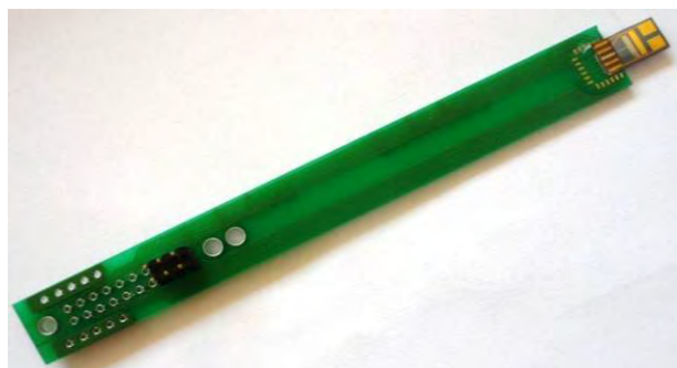
Senzorul de pesticide de unică folosință (IMT)
