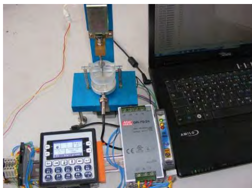
Platformă automată pentru senzorii de pesticide (ROMELGE SRL)
